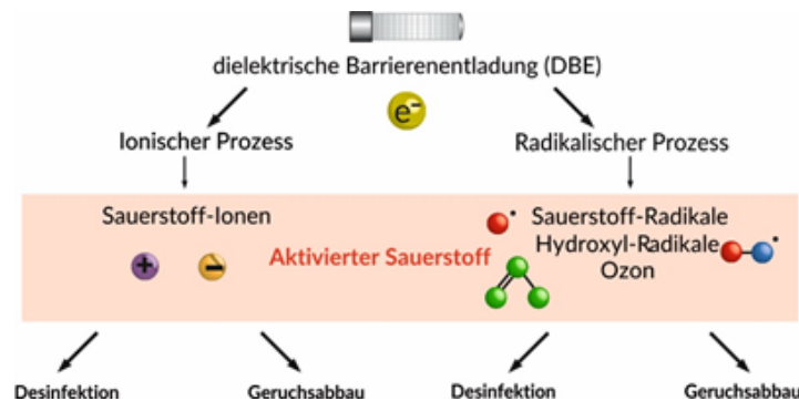
Abb. 1: Funktionsprinzip Ionisation
